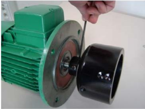
Abbildung 21: Außenrotor auf der Welle befestigen
