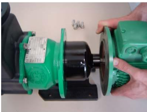
Abbildung 22: Pumpe und Motor montieren
