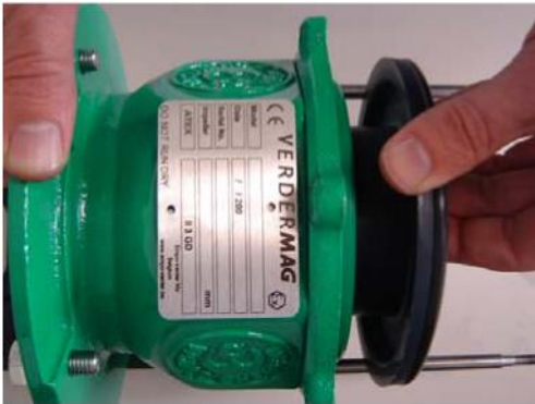
Abbildung 14: Zusammenbau von Spaltpfropfen und Adapterglocke
