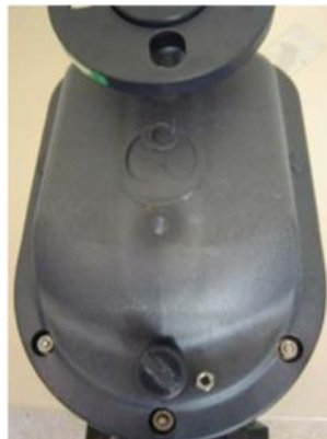
Abbildung 1: Beginn der Demontage von Nassteil / Antriebsteil
