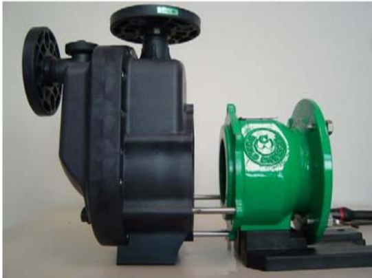
Abbildung 2: Lösen der Inbusschrauben bzw. Schrauben
