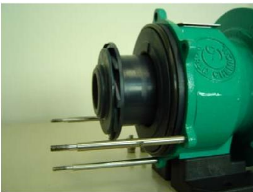
Abbildung 15: Zusammenbau von Laufrad und Spaltpfropfen
