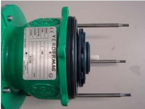
Abbildung 16: Adapterglocke und Laufrad fertig montiert.
