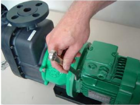
Abbildung 23: Abschluss der Pumpenmontage
