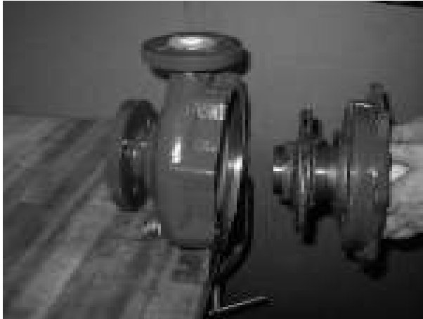
Abb. 14 Einbau des Hvdraulikteil
