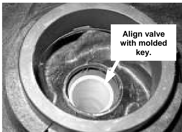
Abb. 41 Ausrichtung des Druckregelventils
