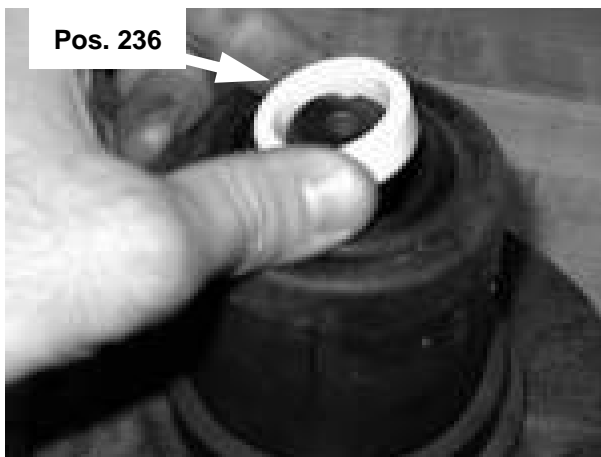
Abb. 49 Einbau der Reduzier- u. Lagerbuchse
